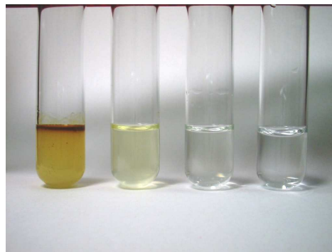
左から、排水原液、アセトニトリル希釈液、C-18固相処理、分子認識ゲル抽出液
