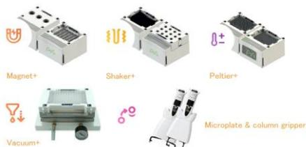
磁気ラック、攪拌ラック、プレート搬送ユニットを組み合わせることで様々な作業の自動化が可能です
